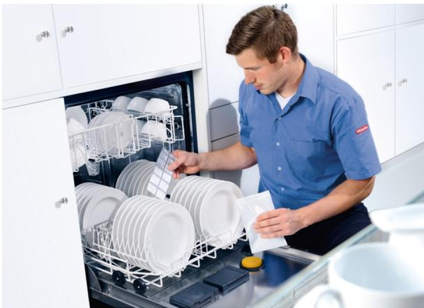
Bioindikatoren, die mit Testkeimen kontaminiert sind, werden zusammen mit dem benutzten Geschirr gewaschen. Anschließend untersucht ein unabhängiges Labor, ob noch Keime auf dem Indikator nachweisbar sind ? und das Ergebnis kann bei Bedarf dem
